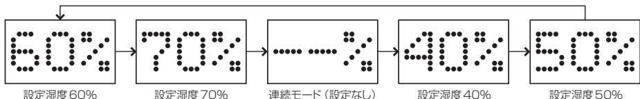
※湿度を50%に設定した場合、周囲の湿度が50%より低いときはミストを発生し、50%に達するとミストの吹出しを自動的に停止します。(湿度センサーを動かせるファンモーターは動作しているため、吹出口からの送風は継続します。) 現在湿度が設定湿度より低くなったとき、ミストの吹出しを自動的に再開します。
